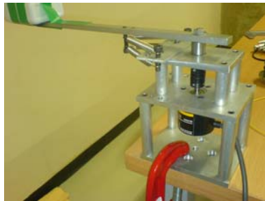
ภาพที่ 3 แสดงลักษณะการยึดhubติดกับโต๊ะ
