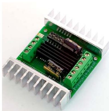
ภาพที่ 2 แสดงวงจรขับมอเตอร์กระแสตรง (Power Amplifier)
