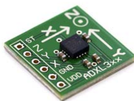
ภาพที่ 4 แสดง Accelerometer
