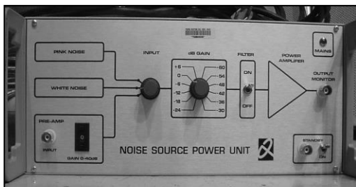
รูปที่ 3 อุปกรณ์แหล่งกำเนิดเสียง (noise source)
