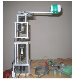
รูปที่ 5 แสดงโครงสร้างของแขนกลแบบข้อต่อยืดหยุ่นได้
